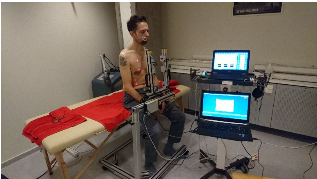
Figur 2: Sittande mätning av andningsrörelser (med Respiratory Movement Measuring Instrument RMMI) och psykofysiologisk mätning av ETCO 2 , hjärt- och andningsfrekvens (med Air-Pas cStress).
